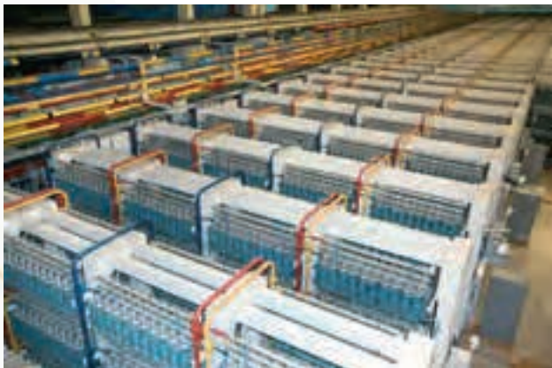
Каскад газовых центрифуг на Электрохимическом заводе
